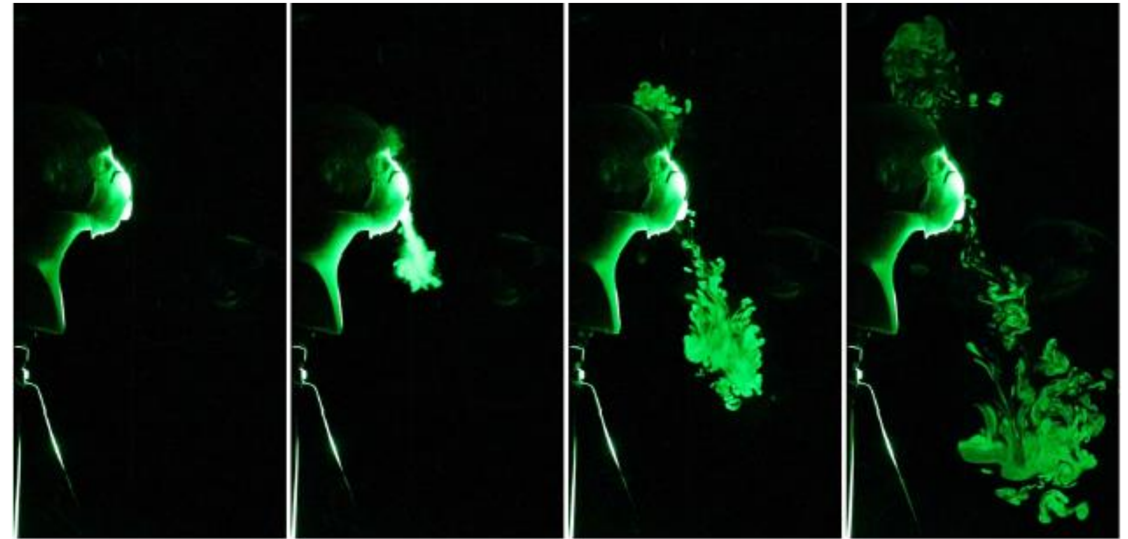
Con válvula. (a) antes de toser; (b) 0.2 s después de toser; (c) 0.63 s después de toser; (d) 1.67 s después de toser
