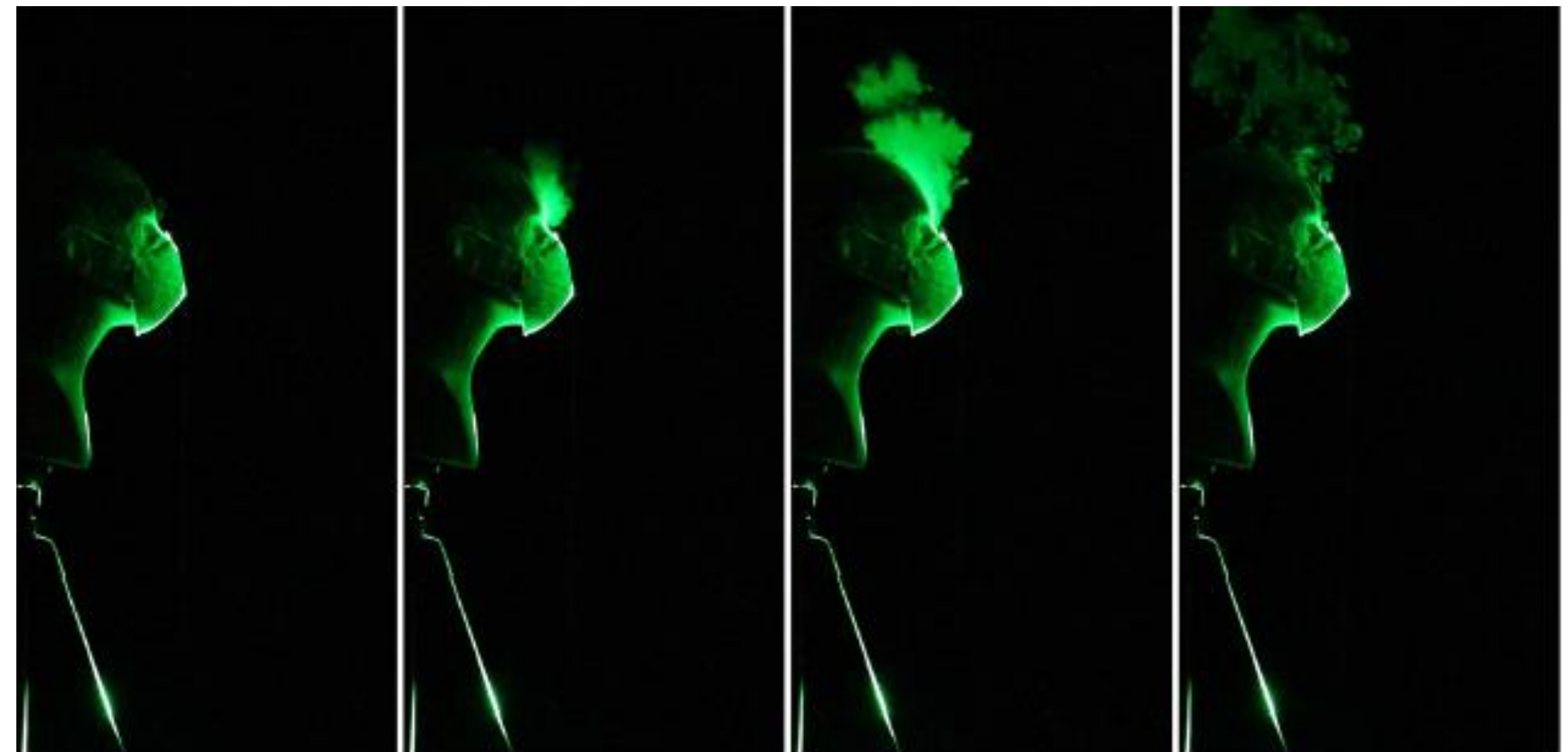
Sin válvula. (a) antes de toser; (b) 0.13 s después de toser; (c) 0.33 s después de toser; (d) 0.83 s después de toser
